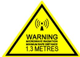
Pour une antenne **SAILOR 500 FleetBroadband**, la distance de sécurité minimale avec le panneau de l'antenne sur l'axe focal est de 1.3 m, sur la base d'un niveau de radiation émis de  $10 \text{ W/m}^2$ . L'appareil génère un niveau de radiation de  $100 \text{ W/m}^2$  à une distance de 0.4 m de l'avant du panneau de l'antenne. Veuillez consulter le schéma sur la page suivante.
