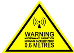
Pour une antenne **SAILOR 250 FleetBroadband**, la distance de sécurité minimale avec le panneau de l'antenne sur l'axe focal est de 0.6 m, sur la base d'un niveau de radiation émis de 10 W/m<sup>2</sup>. L'appareil génère un niveau de radiation de 100 W/m<sup>2</sup> à une distance de 0.2 m de l'avant du panneau de l'antenne. Veuillez consulter le schéma au-dessous.
