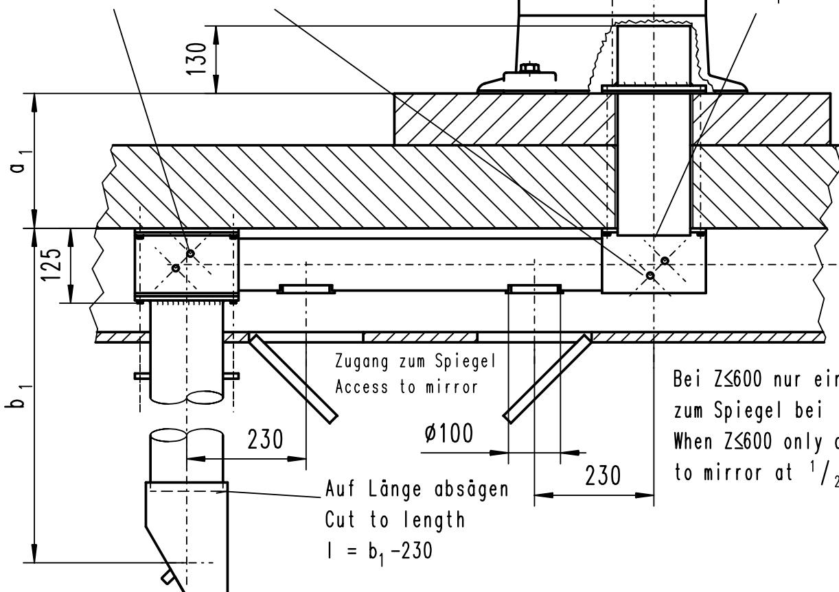
Umlenkung muß parallel zur Mittschiffslinie verlaufen
